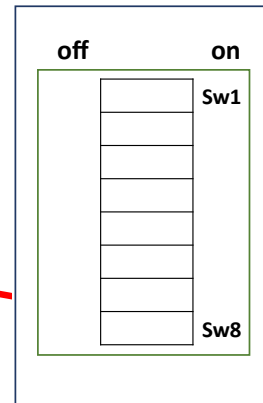
Fenêtre d'accès aux micro-switch
